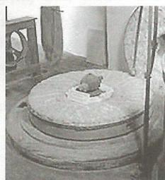
**6. Die Rendel** (Röndle oder Aspirator) Direkt anschliessend an die Rölle wird
