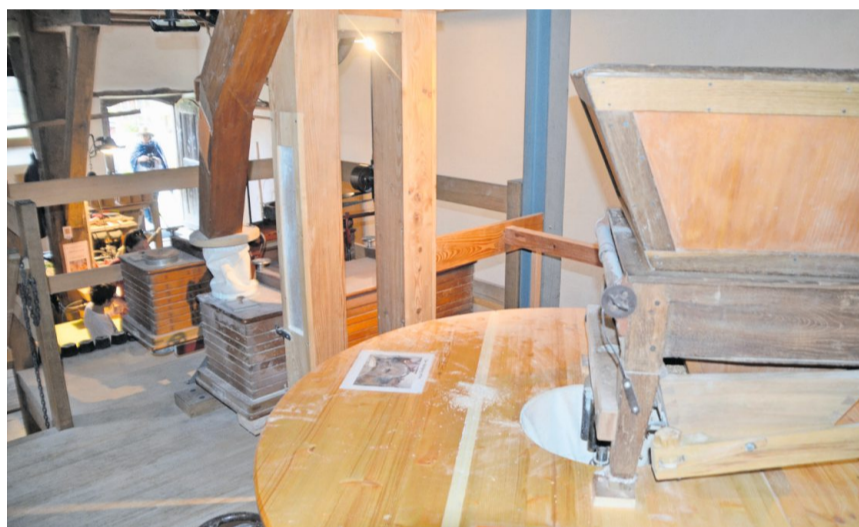
Der Mahlgang (vorne) ist das Herzstück der Mühle.
